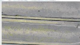
散热器切片内表面基本无腐蚀
